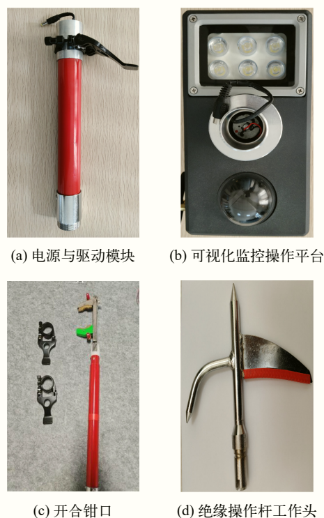
图4 绝缘操作杆部分实物图
